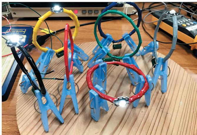
複数の中継コイルと受電コイルを用いた給電結果
