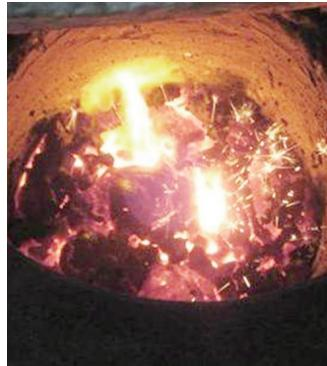
高周波炉でのたたら鉄の精錬(ノロ除去)の様子
