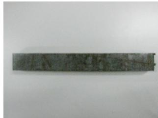
板状素材を切断した鍛造前素材
